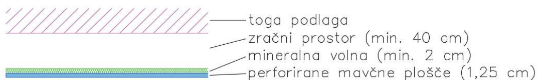
Slika 3: Sestava absorpcijskega stropnega sistema v pisarniških prostorih.
